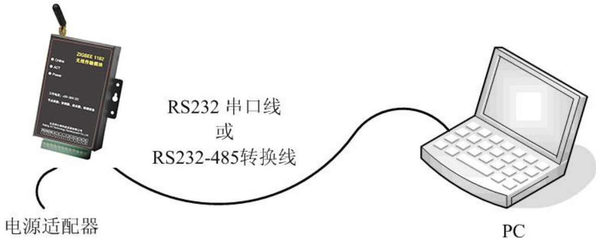
图4-1 ZigBee1182 与 PC 的配置连接
