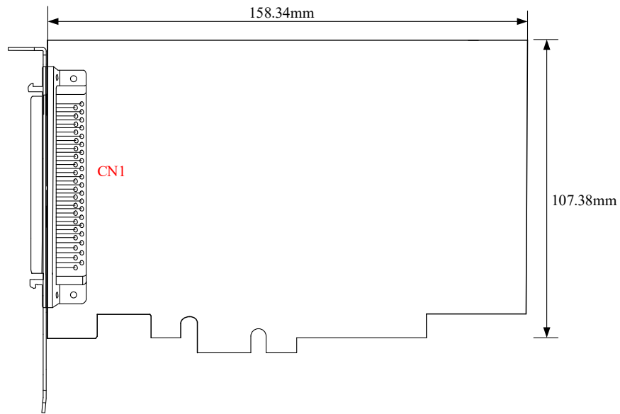
图 3-2-1 PCIe2330A/ PCIe2332A 尺寸图
